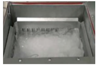
アルコール 35%焼酎甲種を凍らせた状態で食品を急速冷凍している様子。
